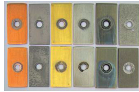
Statische Korrosion in Anlehnung an ASTM D 1384 Prüflüssigkeit: 1.5 % v/v Protectogen C aqua in ASTM-Wasser Prüfdauer: 336 Stunden
