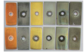
Statische Korrosion in Anlehnung an ASTM D 1384 Prüflüssigkeit: 1.5 % v/v Protectogen C aqua in ASTM-Wasser Prüfdauer: 1000 Stunden
